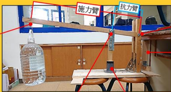
【炭粉餅擠壓成型機】 施力點 抗力點 裝碳粉、擠壓成炭粉餅的容器
