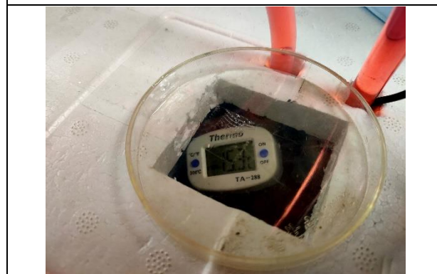
圖 31 於循環水桶中放置溫度計
