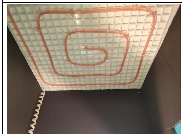
圖 21 回字型冷卻水管實驗狀況
