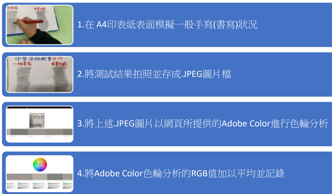
圖五：自製簡易的環保永恆鉛筆筆芯書寫效果分析流程圖
