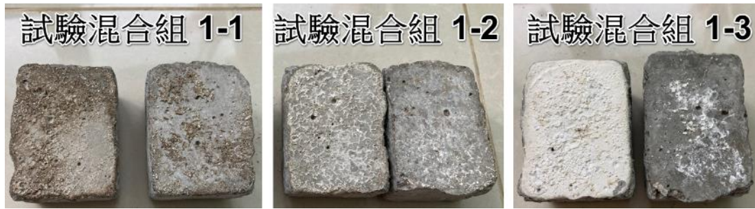
此附圖(六) 為被拉開後的水泥塊，中間的填縫水泥狀態
