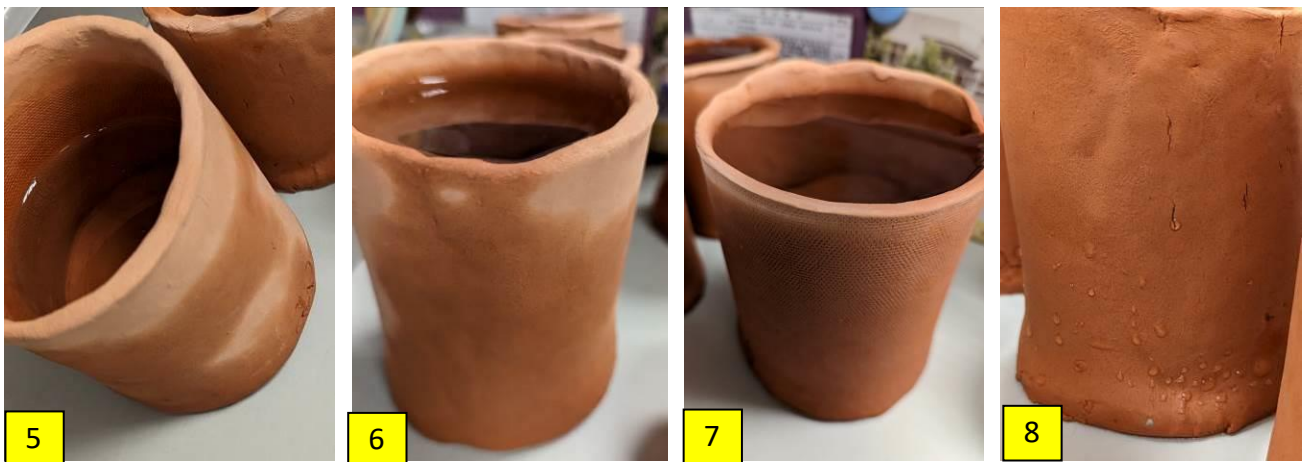
圖 12 水溶液會慢慢吸滿整個陶濾芯，最後就會從表面開始滲出
