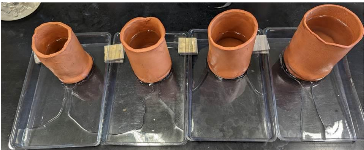
圖 10 過濾後的溶液會流到塑膠水盆的低處低，再倒入燒杯中進行檢測
