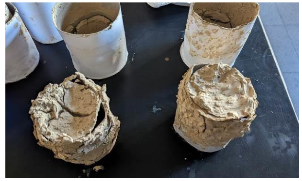
圖 24 乾燥速度太快全部都裂開無法使用
