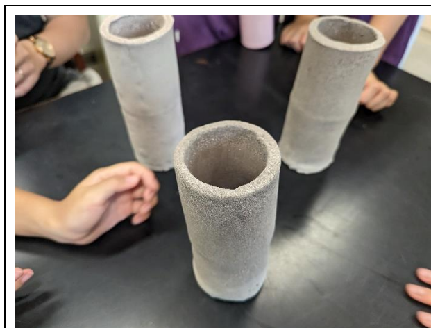
圖 40 第五次製作長圓柱狀陶濾芯
