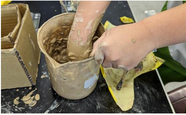
圖 23 加入水後混和泥漿和麵粉
