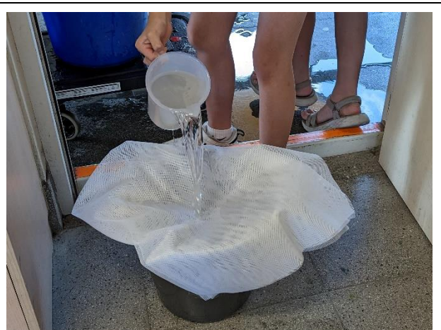
圖 20 溪水用紗網過濾後才進行後續實驗
