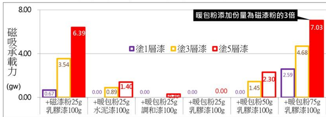
圖3-3 暖包粉漆的磁吸承載力比較
