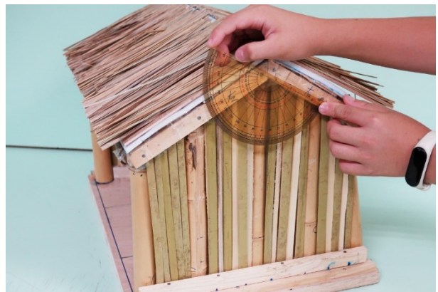
圖 B：「自製竹管厝模型」屋頂為 120° 夾角。
