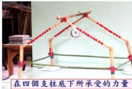
竹管厝屋頂樑柱的結構
