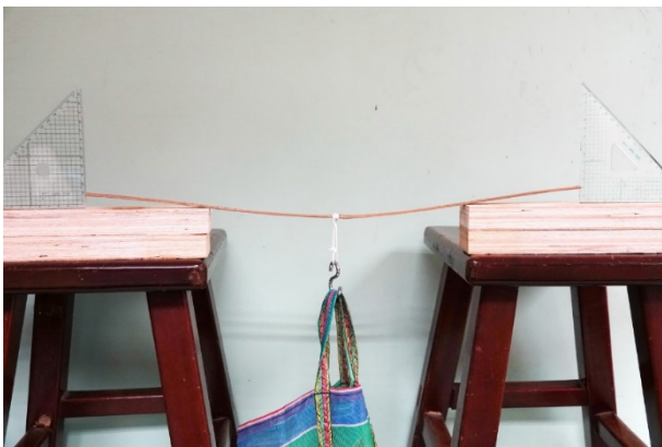
圖 A：竹片放置在桌面上，中間吊重物，二端翹起高度。
