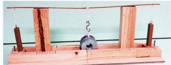
竹片兩端翹起的力量測量實驗裝置
