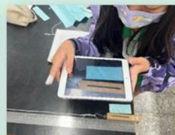
將彈簧秤固定在桌上，分別從另一邊綁上不同下落長度的繩子，再掛上不同數量的積木。用慢動作拍攝，回放後記下瞬間拉力。
