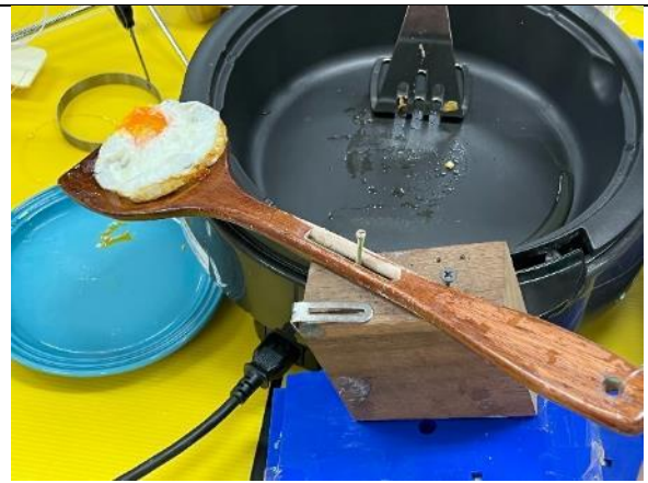
8. 利用傾斜架子，把蛋平移動、蛋傾斜入盤動作兩個動作二合一。 (動作三:移同時轉)
