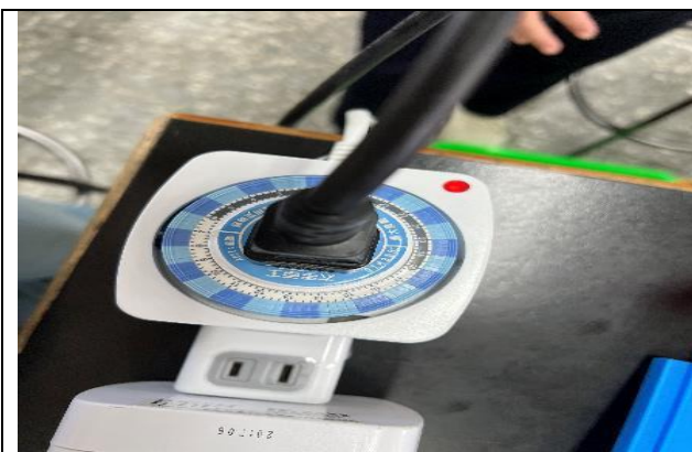
計時器 1：設定 6:00 通電用 220 度加熱鍋子
