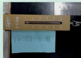
將彈簧秤固定在桌上，分別從另一邊綁上不同下落長度的繩子，再掛上不同數量的積木。用慢動作拍攝，回放後記下瞬間拉力。
