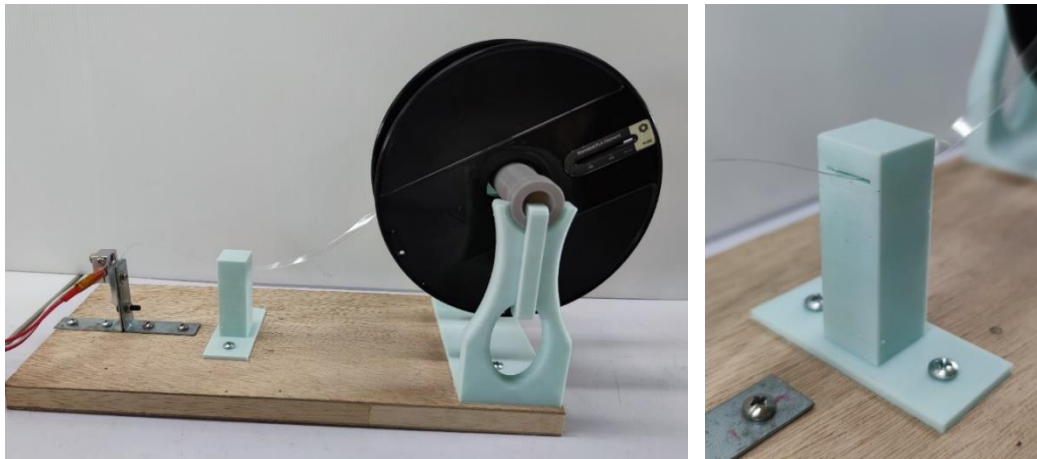
圖 4-7-1 「PET 條送料模組」及「PET 條整線器」特寫，黑色圓盤為空線軸
