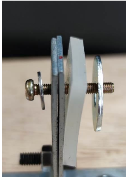
圖 3-5-5 加熱頭新增螺絲墊片及矽膠墊片分布
