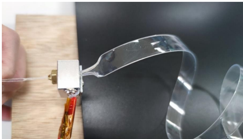
圖 4-5-2 擴孔後的結果顯示，PET 條融化的形狀已經變成平滑三角形
