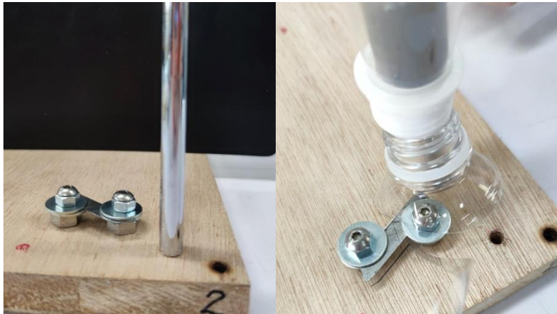
圖 3-3-1 不同刀具角度的安裝方法及增加寶特瓶固定器
