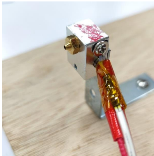
圖 4-4-1 製作完成的線材成型加熱模組
