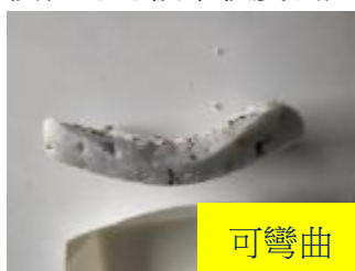
圖 20 複合泡泡板柔軟度測試過程
