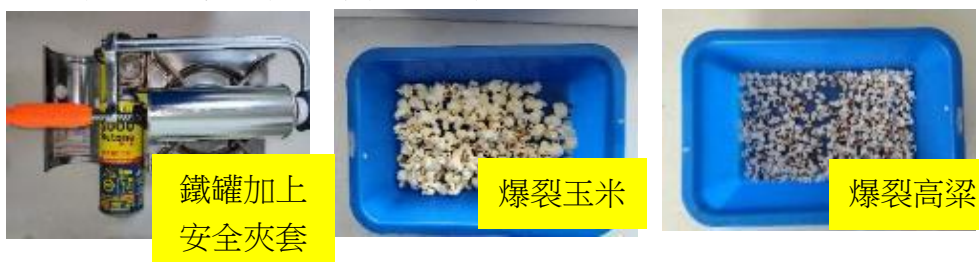
壓力罐安全改善過程及爆裂穀物外觀
