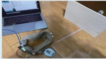
圖5-5 Arduino IDE超音波感測器精度與準度實驗圖
