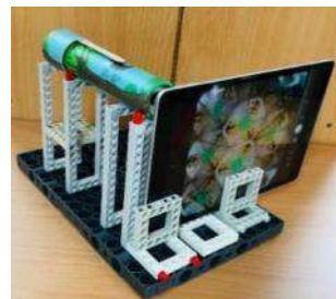
圖10.鏡筒水平放置型拍照架
