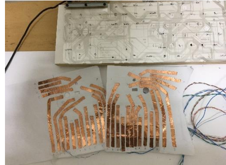
圖 1-8 以銅箔為導通按鍵測試
