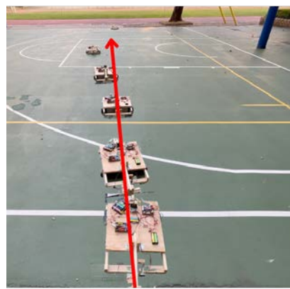
安裝電子羅盤後
