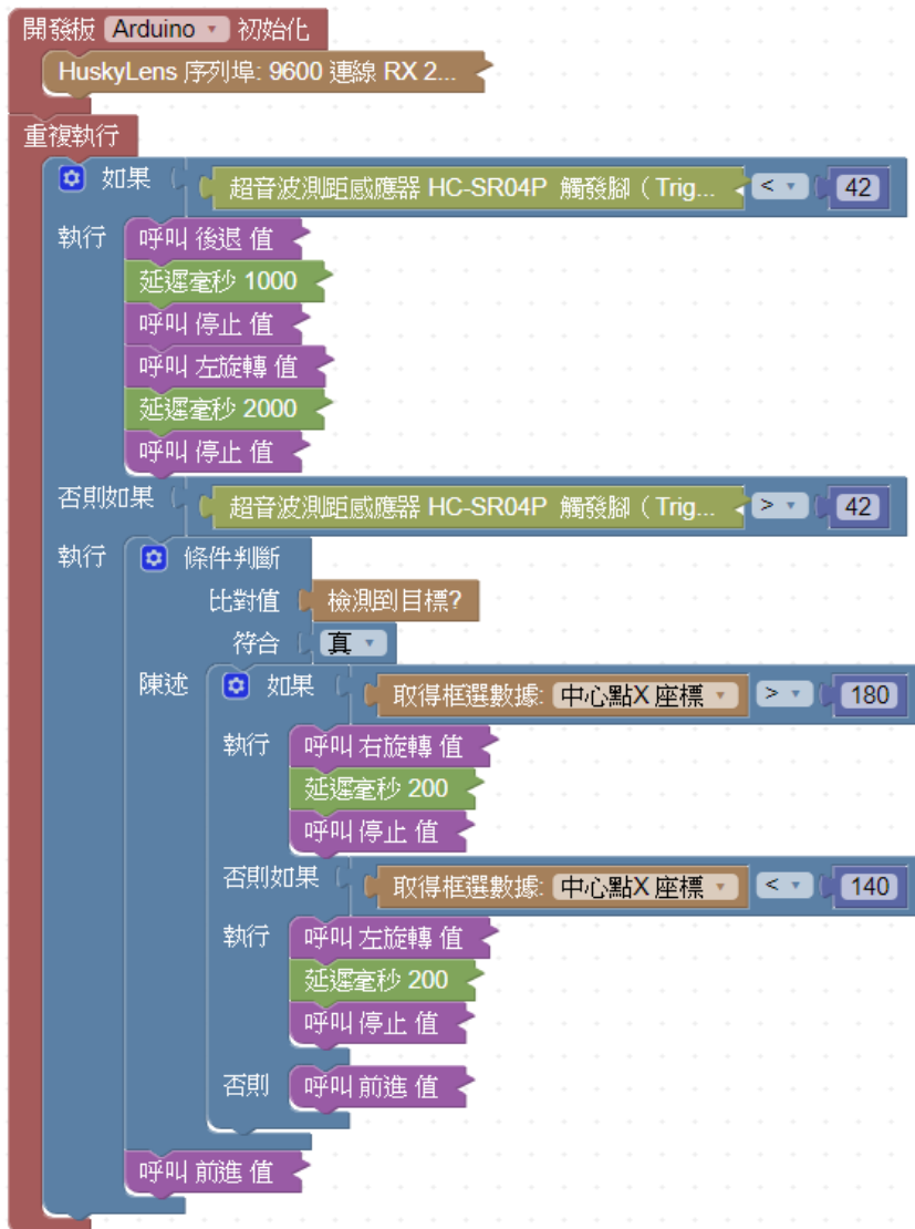
圖 10 AI 辨識撿取乒乓球自走滾筒程式積木
