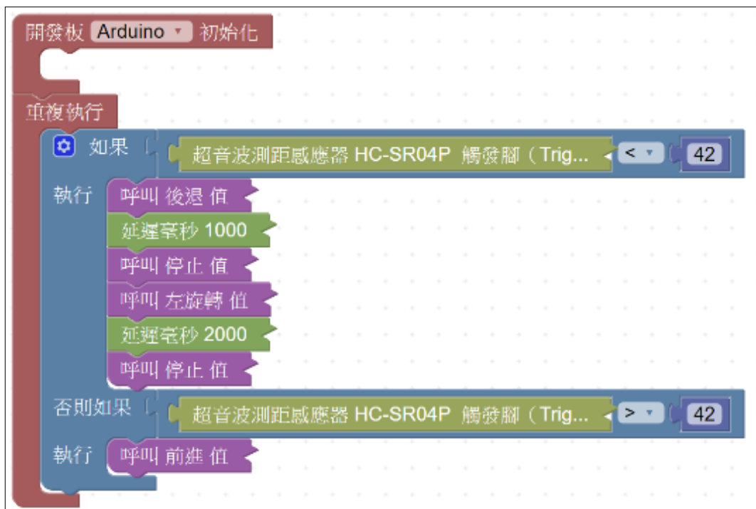
圖 2 推動輪的超音波感測器修正後設定程式
