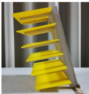
[圖 4] 立體 15 度角調整器 減少 量測誤差。
