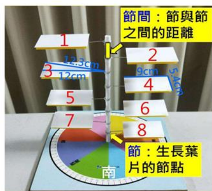
[圖 3] 太陽能模擬樹： 控制 各樹型樹寬、高、葉片數量大小等 變因 。
