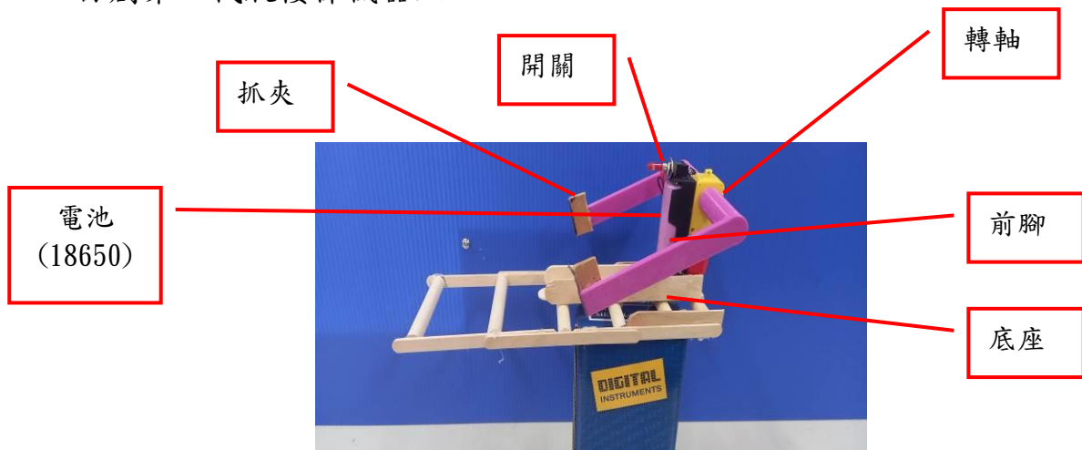
圖 5：第二代爬樓梯機器人結構
