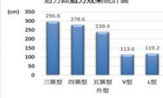
圖 26：1000P 白銅紙製成之不同外型迴力鏢滯空時間統計圖
