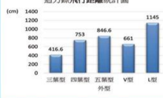
圖 28：1000P 白銅紙製成之不同外型迴力鏢迴力效果統計圖
