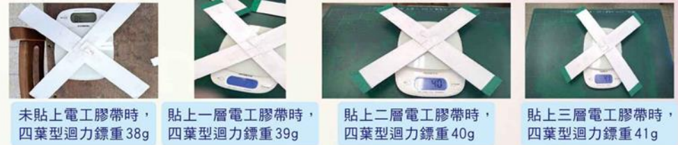
未貼上電工膠帶時，四葉型迴力鏢重38g 貼上一層電工膠帶時，四葉型迴力鏢重39g 貼上二層電工膠帶時，四葉型迴力鏢重40g 貼上三層電工膠帶時，四葉型迴力鏢重41g
