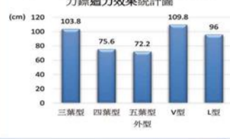
圖 23：500P 白銅紙製成之不同外型迴力鏢滯空時間統計圖
