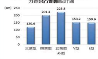
圖 22：300P 白銅紙製成之不同外型迴力鏢迴力效果統計圖
