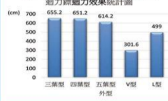
圖 29：四開襯卡製成之不同外型迴力鏢滯空時間統計圖
