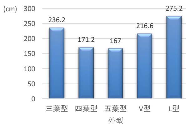
圖24：500P白銅紙製成之不同外型 迴力鏢飛行距離統計圖
