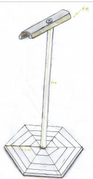
圖 7.42 自製「防傾防危助老柺杖」設計圖
