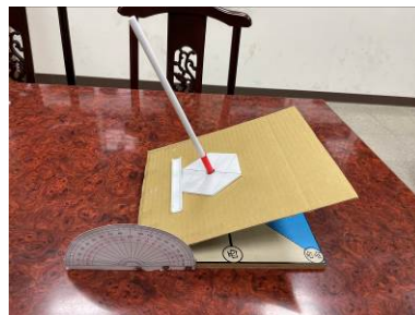
圖 7.6 不同柺杖底面形狀-傾斜角度操作情形
