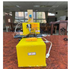
圖 7.24 Webduino 及體溫感測器硬體架設情形
