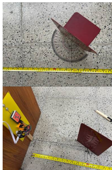
圖 7.19 Webduino 及超音波量測大偏角情形
