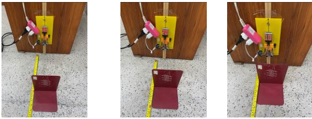
圖 7.14 Webduino 及超音波近距量測情形
