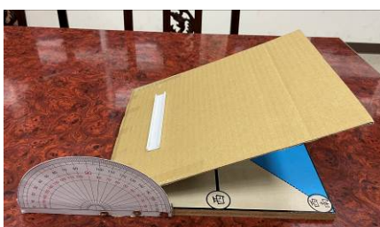
圖 5.6 DIY 研究專用斜板 設置完成
