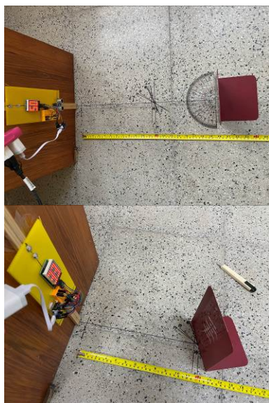
圖 7.18 Webduino 及超音波量測小偏角情形
