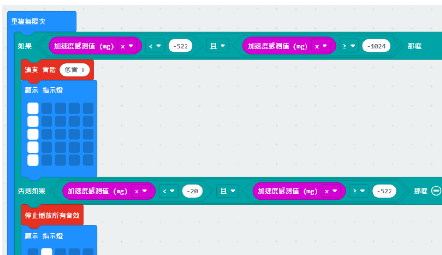
(圖十一) 利用 X 軸的數值差異判斷不同的傾斜程度
