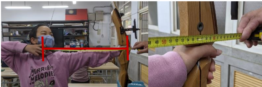
(圖二十六) 紅線距離為測量拉弓的長度
