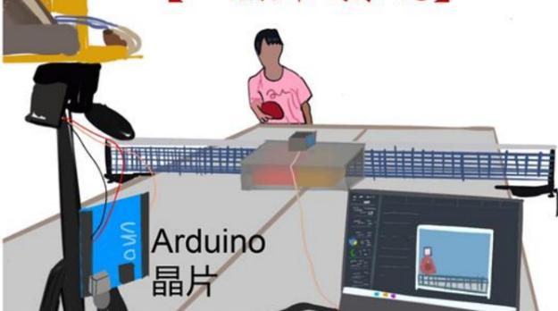
◀透過OpenCV程式庫達到即時人臉辨識並資訊傳送到Arduino晶片/雲台旋轉模組
