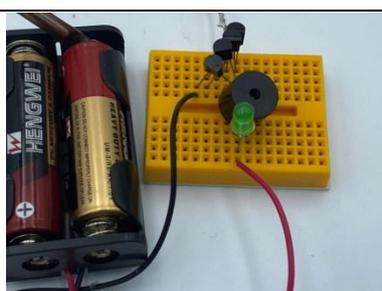
(圖 51) 四顆電晶體感應器
