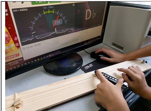
用電腦及拾音器測量弦的音高
