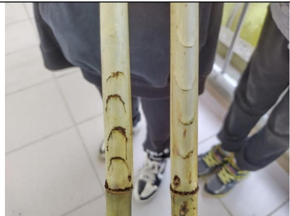
拉出後比較兩支不同方向切痕的口型錨釘
