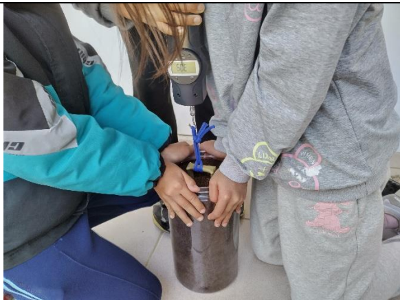
使用拉力彈簧秤將口型錨釘向上垂直拉出
