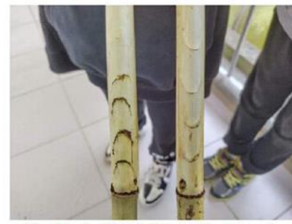
拉出土後比較不同方向切痕的口型錨釘
