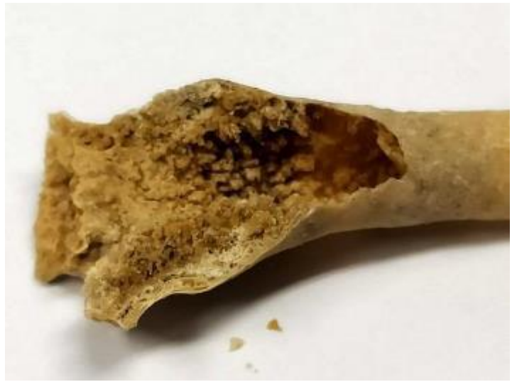
圖 56 橋樑下類鐘乳石內部結構
