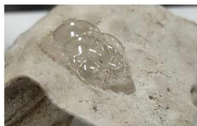
圖21 岩石表面滴酸反應情形
