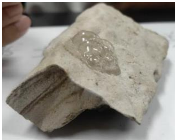
圖 36 炭坑內岩石切片滴酸
