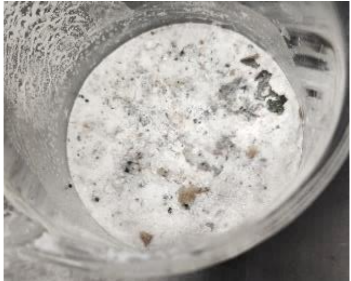
圖 52 粉末組的膠結情形
