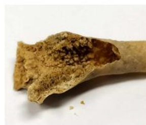
圖32 橋下類鐘乳石內部結構
