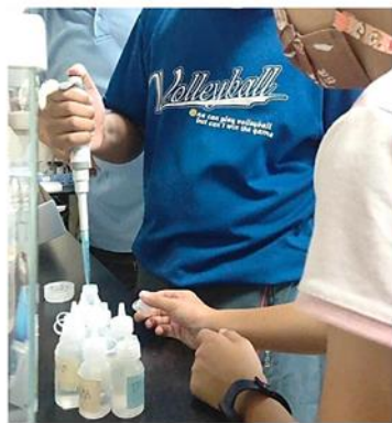
圖5 水樣滴加硝酸
