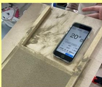
利用手機APP，測量坡度板坡度
