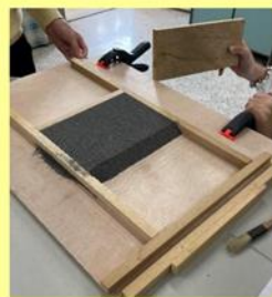
將泥沙鋪平，準備操作鋪沙區--長20cm、寬15cm、高1.5cm
