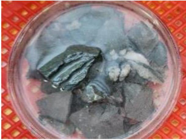
將石墨放入並鋪滿直徑 9 公分的培養皿中，再倒入 65 公克的備製碳酸氫鈣水溶液，淹蓋培養皿內的材料。待皿中的水溶液蒸發後，再加入水溶液。
