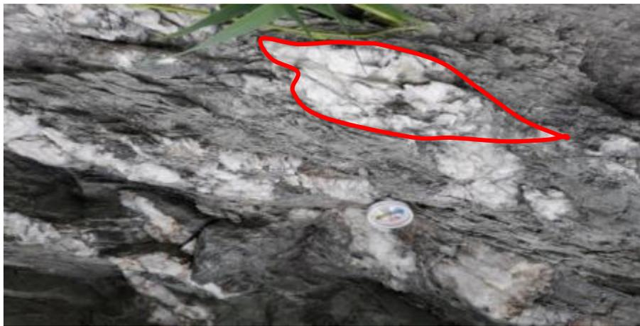
綠色片岩中的礦物\_石英，以近似透鏡夾層方式呈現(如圈起的部份)。
