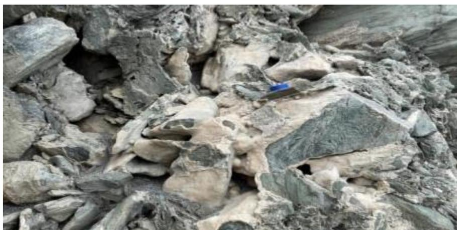
圖片 2：邊坡底層的組成材料，也有綠泥石石塊且孔隙有膠結物填充。
