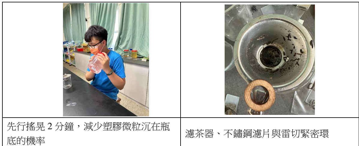
圖 8 海水過濾操作情形與器材
