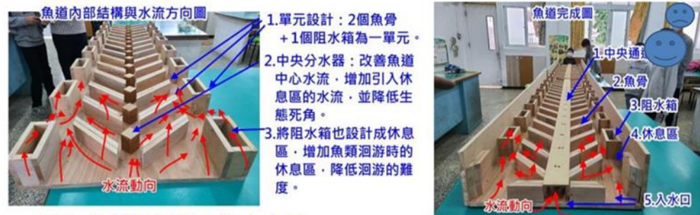
圖5-1 自製魚道水流方向圖
