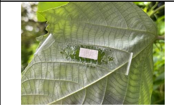
↑圖 18：測量同一部位氯化亞鈷試紙從藍色變成粉紅色所需的時間
