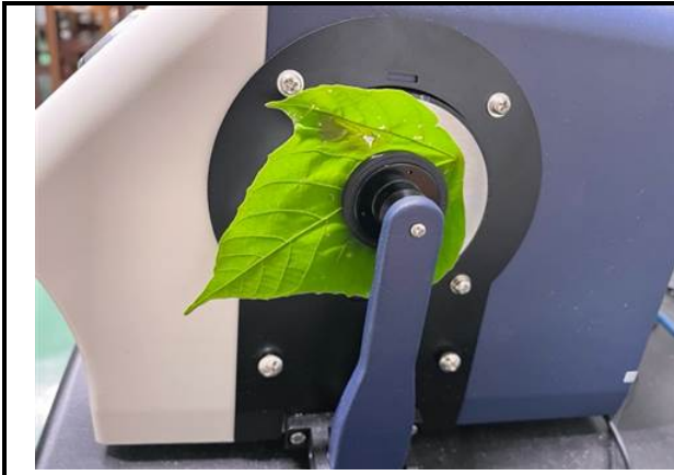
↑圖 11：將白匏子葉子放到測量口，測量葉子上、下表面的反射光譜
