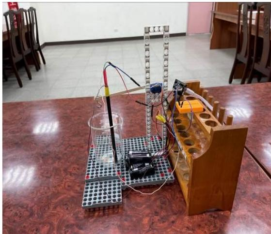
圖 7.22 自製咖啡濃度控制器組立正面
