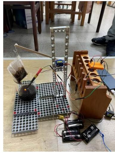
圖 7.25 咖啡濃度控制器-袋裝研磨咖啡濃度到達釣起情形
