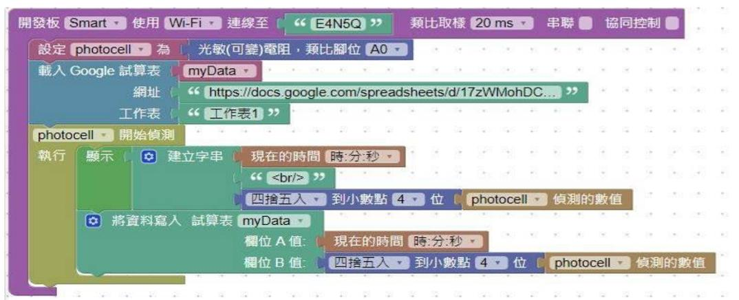
圖 7.16 Webduino、光敏電阻-程式積木編寫情形
