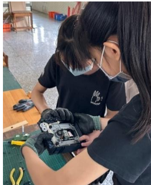
拆除光碟機的外殼，拿取中間的滑軌結構
