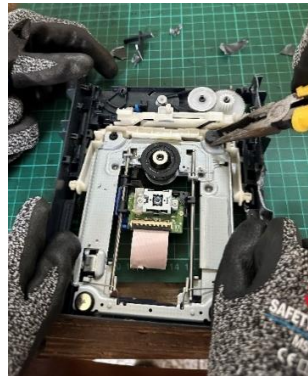
拆除光碟機的外殼，拿取中間的滑軌結構
