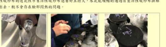
玻璃杯內倒入50ml熱水。在玻璃杯口綁上活性碳紗布，並放置30顆乾燥劑。每10分鐘記錄乾燥劑變色數量。
