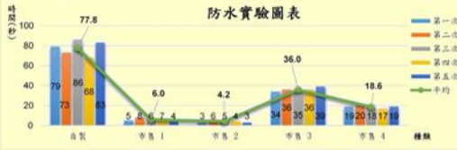
將活性碳紗布用橡皮筋綁在玻璃杯上。將色素水噴灑在活性碳紗布上。記錄色素水滴入玻璃杯的時間。
