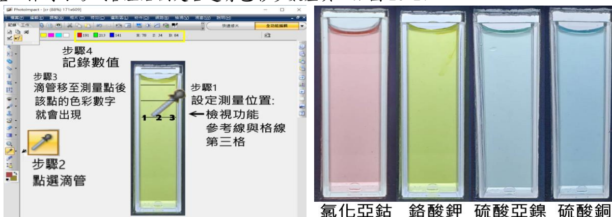
圖 23:以相機拍照的方形試管色彩參數測量方法流程(左)與溶液方試管內實際顏色(右)
