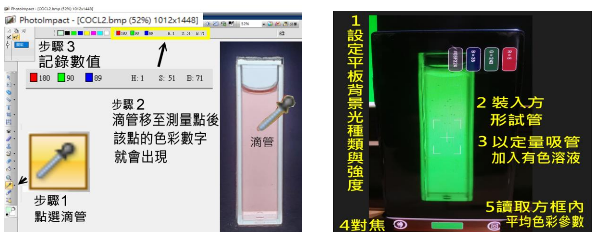
圖 14: 兩種數位偵測色彩參數方法操作步驟: Photoimpact 軟體滴管法 (左), 手機 app(colormeter) 即時測量色彩參數法(右)
