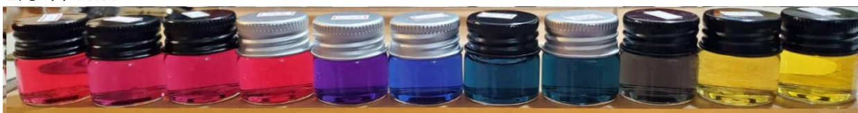
圖 01: 蝶豆花水溶液在酸鹼中的顏色變化，不同光源顏色會有變化(左側瓶是酸性實驗)，幾小時後鹼性瓶中顏色由墨綠變成黃色(右側瓶是鹼性實驗)
