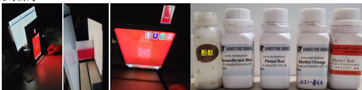
圖 51:指示劑色彩參數測量實驗裝置(左,以甲基紅為例);五種指示劑(右)
