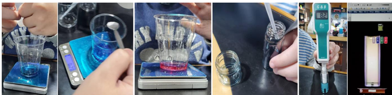
圖 16: 配置指示劑與蝶豆花酸鹼混合液:滴瓶加酸鹼溶液(左一)，加小蘇打粉末(左二)，加蝶豆花原液(左三)，移至玻璃瓶測酸鹼度(右二, 右三)，以手機 app 即時測量色彩參數(右一)
