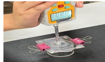
圖 12 自製薄膜穿刺力測試設備
