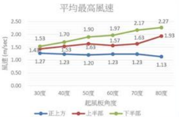
圖58 氣流飛機在不同位置時，不同起風板所測得的「平均最高風速」關係圖
