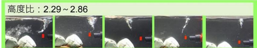
3. **最佳高度比區間(1.86~2.14)**產生的渦流，和區間外的渦流強弱似乎有所不同，八種高度比的渦流側面截圖，可以看出渦流的速度有明顯差異。
