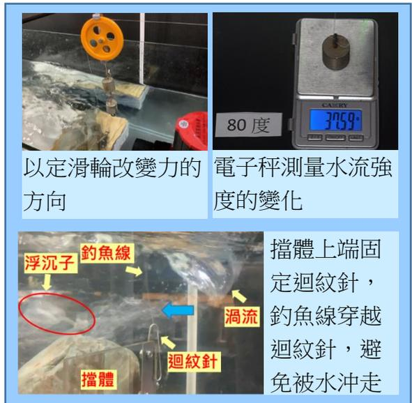
我們使用定滑輪改變施力方向，以電子秤(最小刻度：0.01g)來測量數據，以釣魚線綁在電子秤上的砝碼，線經過兩個定滑輪，穿過固定在擋體上的迴紋針，尾端綁上浮沉子。當水泵未啟動前，電子秤上的數值為砝碼的重量，當水泵一啟動，浮沉子被水流拉扯，牽動到砝碼，會讓數值產生變化，當有渦流產生時，會增加水流的強度，讓數值變少。
