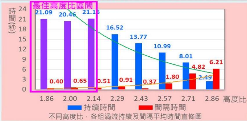
2. 高度比在**1.86到2.14間**，渦流形成的效果最好。高度比越高，持續時間會越短，間隔時間會越長，最後甚至呈現間隔時間比持續時間長的狀況，相較於流速，高度比對阻擋型自由渦流產生的影響，似乎更為重要。
