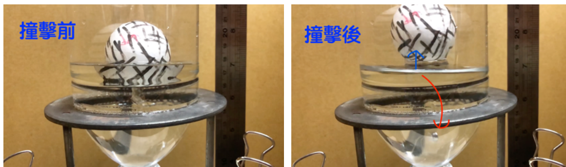
圖22、5公分保麗龍球受到撞擊磁鐵脫落，保麗龍球受到浮力作用噴出水面
