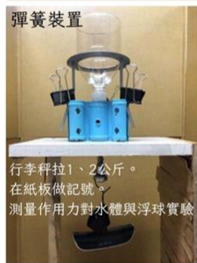
實驗三、探討撞擊波撞擊寶特瓶對瓶內水體與浮球的影響
