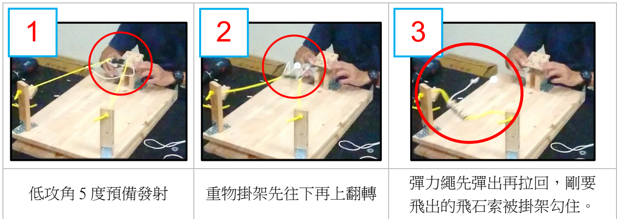
圖 26：第 2 代飛石索和重物掛架勾在一起的情形
