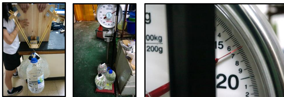
圖 28：利用桶裝水的重量測量第 3 代發射器的拉力
