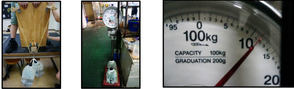
圖 22：利用桶裝水的重量測量第 2 代發射器的拉力
