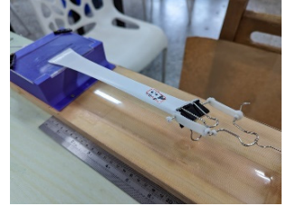
圖 23：1mm 厚度 S810 乾式膠帶形變拉很長。
