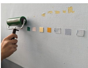
圖 8：將膠帶貼在水泥牆，測試是否黏殘渣。
