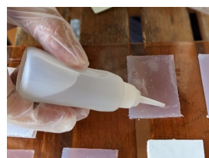
圖 51：塗上矽膠表面處理劑（老師操作）。
