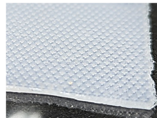
圖 47：製作出 1.25mm 十字形狀的乾式膠帶。
