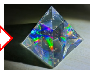
圖 56：製作出底部有光柵效果的立體模型。
