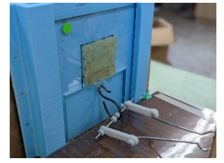
圖 15：測量剝離力，自製乾式膠帶皆易剝離。
