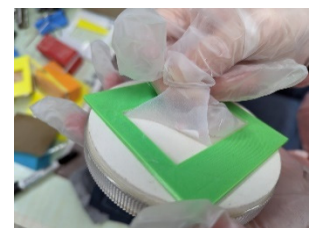
圖 30：剝下奈米氣泡石上的乾式膠帶。
