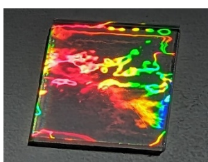
圖 54：利用光柵矽膠模製作出的環氧樹脂。
