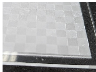
圖 46：直橫交錯形狀的自製雷雕柵欄。
