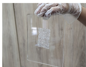
圖 13：以壓克力板檢測自製膠帶是否黏貼。
