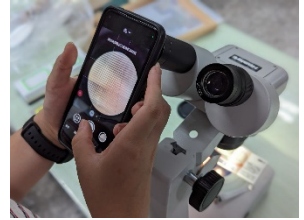
圖 34：以解剖顯微鏡和手機拍攝壓印板結構。
