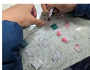
圖 9：以透明方格紙計算膠帶黏殘渣百分比。
