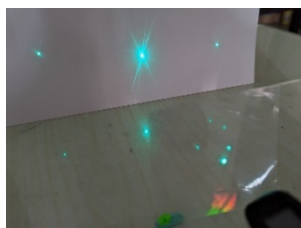
圖 49：1000 條光柵片以雷射筆照射會有干涉。
