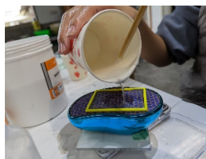
圖 28：以磨腳皮石當作壓印板製作膠帶。
