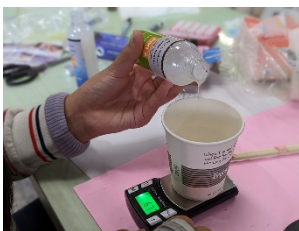
圖 16：購買各種硬度矽膠，秤重作膠帶。
