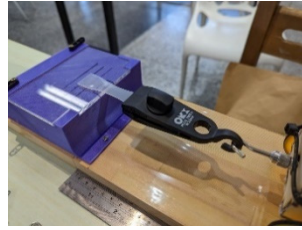
圖 32：光碟片壓印的膠帶，剪切力很大。
