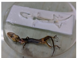
圖 25：壁虎腳趾太軟又太細，壓印失敗！
