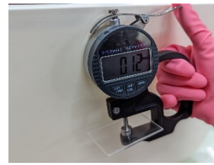
圖 14：以厚度計測量自製乾式膠帶的厚度。
