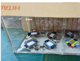
圖 12：膠帶硬化時放在水族箱中，避免灰塵。
