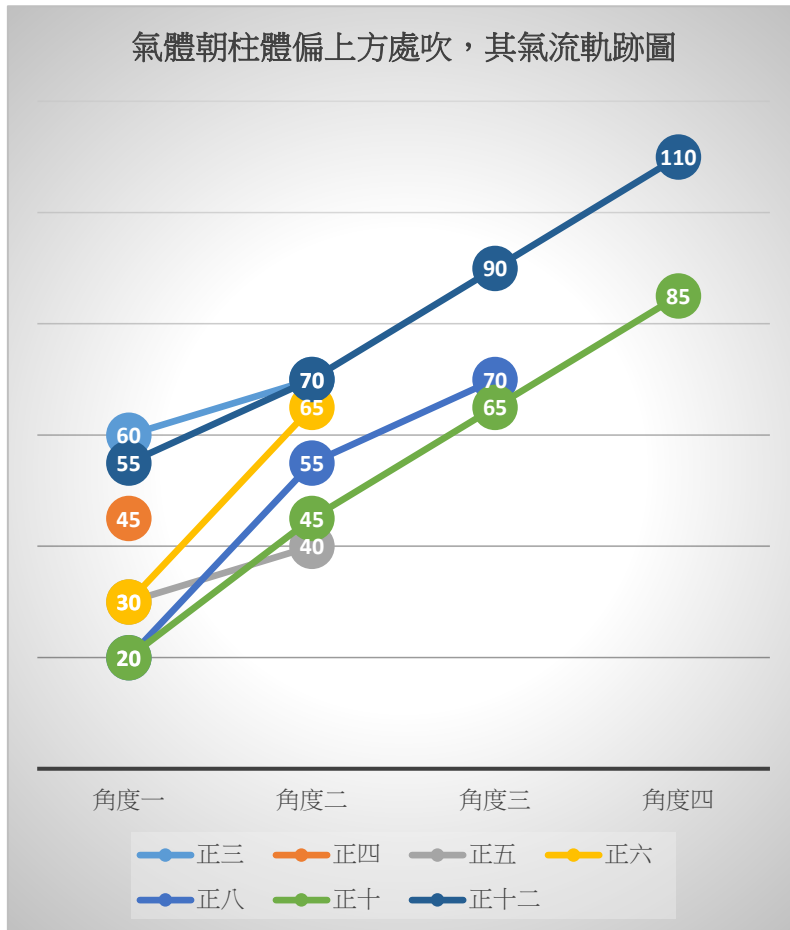
圖 4-23 氣體朝柱體偏上方吹，其氣流軌跡圖
