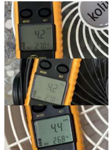
圖 7c 測量三個循環扇的平均風速。
