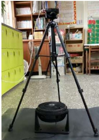
圖 7a 實驗裝置—循環扇正面向上，相機立於正上方。
