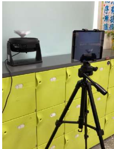
圖 7b 側拍裝置—水平側拍陀螺旋轉情形。
