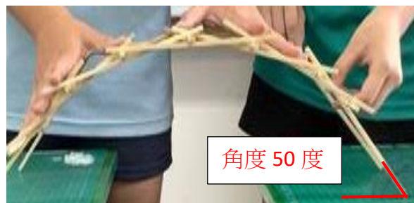
圖 9 三層的達文西橋角度已達到 50 度
