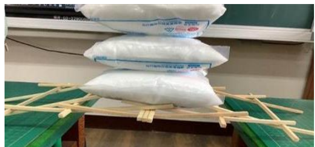
圖 12 中間底座三根橋體，在承重 3 公斤呈現凹陷
