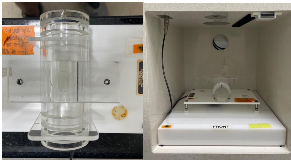
圖五 動物驚嚇反應測試箱與箱內之驚嚇反應偵測裝置
