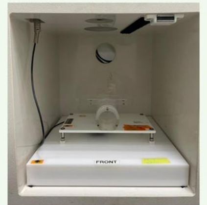
圖五 動物驚嚇反應測試箱與箱內之驚嚇反應偵測裝置
