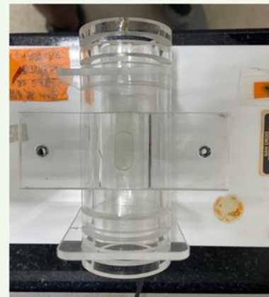
圖五 動物驚嚇反應測試箱與箱內之驚嚇反應偵測裝置
