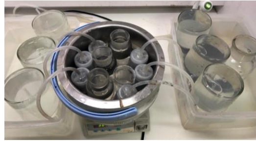
圖 3-3 恆溫水槽裡發酵中反應瓶
