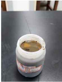
圖 3-2 柿皮、汙泥與培養基混合反應瓶
