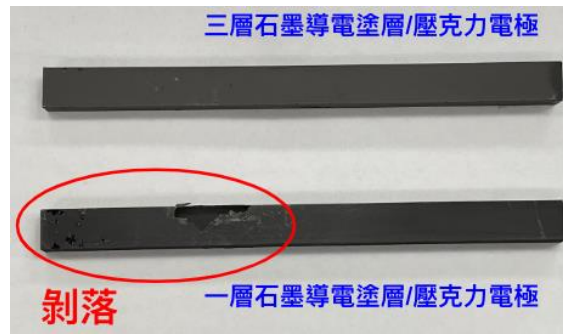
圖二十七、噴塗三層與一層之石墨導電塗層/壓克力電極使用後剝落情形比較圖
