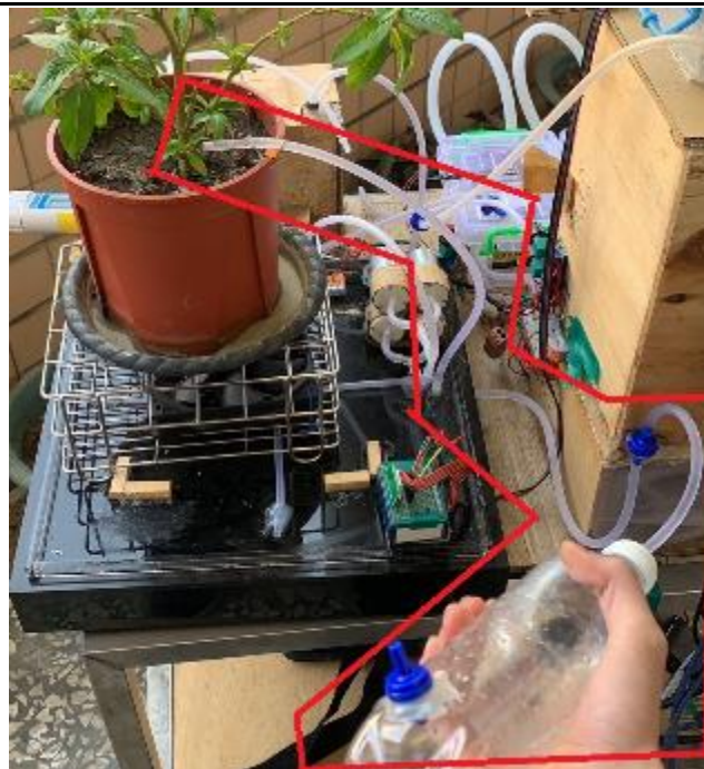
(圖二十一)管線穿過底座連結盆栽
