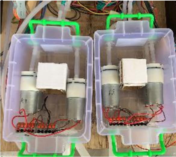
(圖十六)左右側依序為第一、第二箱進氣幫浦 (圖十七)3D 列印接頭與矽膠管連接
