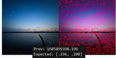
不同時間嵌入但可還原浮水印的兩張圖片，程式偵測時間戳無效
