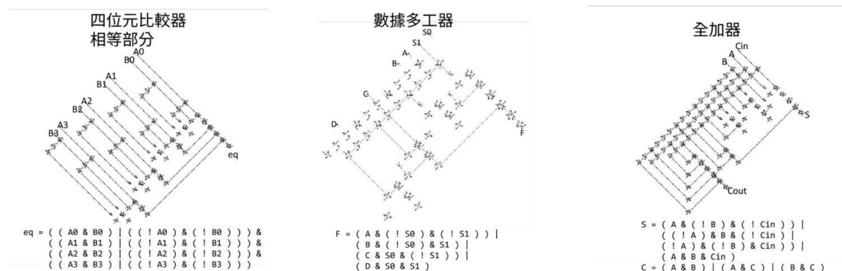
圖二十四 由布林函式所生成的電路
