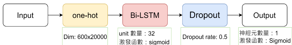
圖 3-15：使用 one-hot 編碼的雙向 LSTM 模型架構
