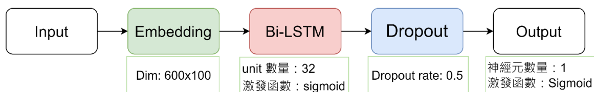
圖 3-16：使用詞嵌入編碼的雙向 LSTM 模型架構
