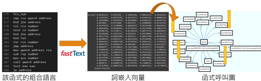
圖 4-18：以函式呼叫圖進行圖神經網路運算示意圖
